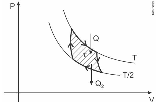
Essa máquina retira uma quantidade de calor  $Q$  de um reservatório térmico à temperatura constante  $T$ , realiza um trabalho total  $\tau$  e rejeita um calor  $Q_2$  para a fonte fria à temperatura  $\frac{T}{2}$ , também constante.
